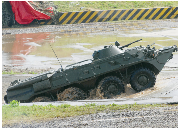
Конструкция БТР-80 позволяет ему не только плавать при волнении до 3 баллов, но и выходить из воды на необорудованный берег.
