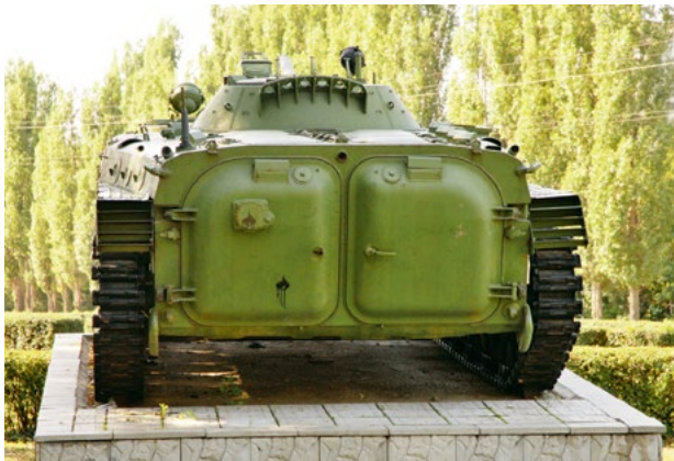
Характерной особенностью БМП-1 были полые задние двери десантного отсека, использовавшиеся в качестве баков для дизтоплива.
