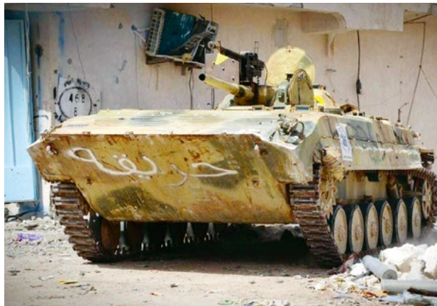
Множество БМП-1, принадлежавших иракской, ливийской и сирийской армиям, попало в руки различных группировок на Ближнем Востоке. У этой машины над стволом пушки «Гром» закреплён крупнокалиберный пулемёт КПВТ.
