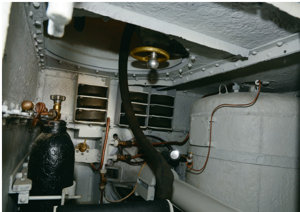
Вид на интерьер XT-26 через люк механика-водителя. За его сиденьем закреплены баллоны со сжатым воздухом, а слева находится бак для химических веществ. На задней стенке закреплены стеллажи с дисками для пулемёта.
