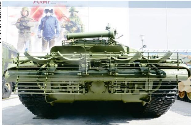
Двигательный отсек танка дополнительно прикрыт стальными решётками для защиты от выстрелов ручных противотанковых гранатомётов.
