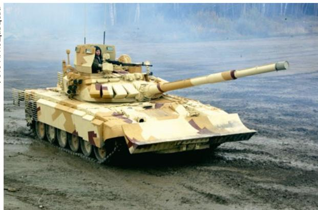
Один из вариантов дальнейшей модернизации танка, предложенный УВЗ: Т-72Б3 с усиленной динамической защитой, забронированной пулемётной установкой на башне и бульдозерным отвалом для разгребания завалов при боях в городской застройке.
