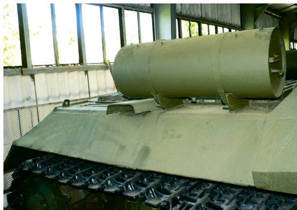
Под внешним цилиндрическим топливным баком видна броневая крышка выхлопной трубы двигателя.
