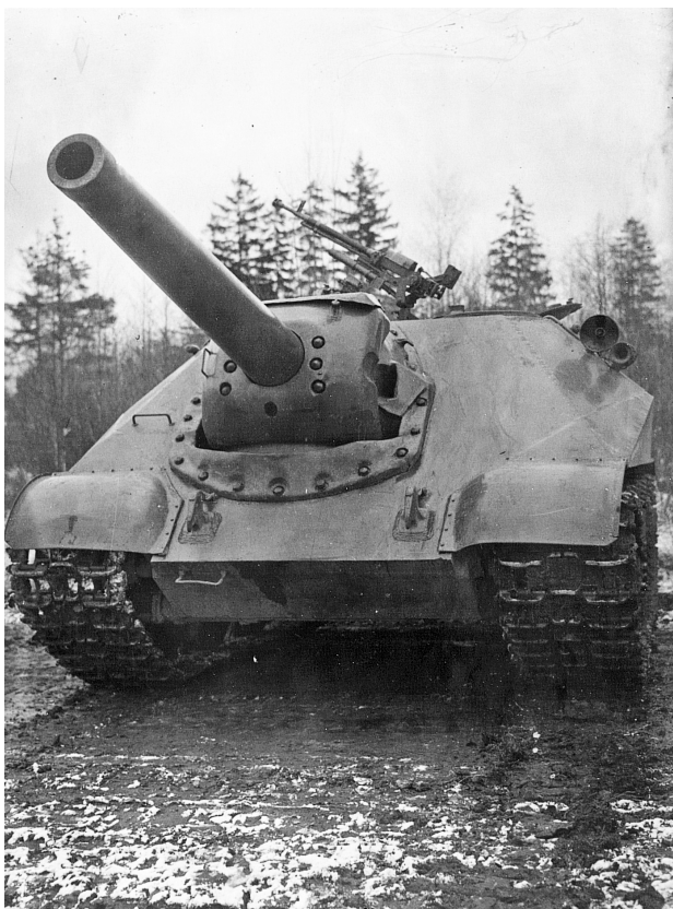
Защита передней части новой САУ не имела ослабленных зон и могла противостоять любому обстрелу.
