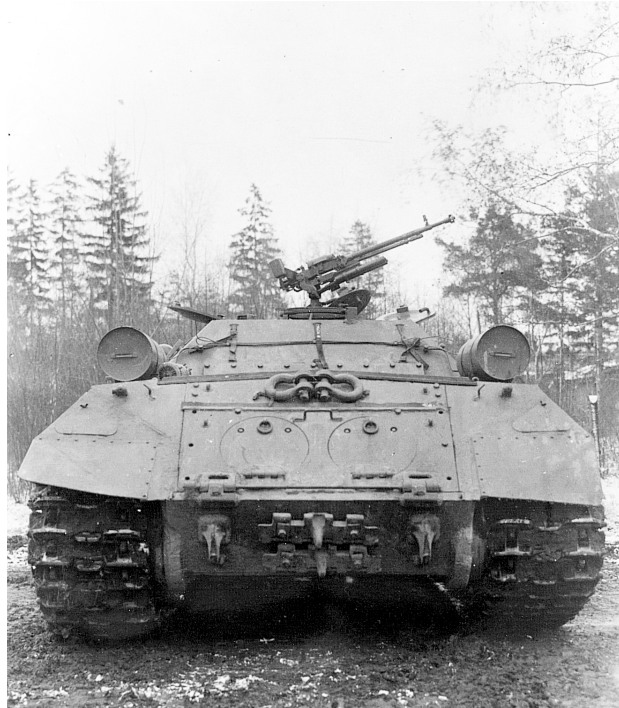
На задней плите корпуса располагались люки доступа к трансмиссии САУ. По бокам крыши моторного отсека установили дополнительные баки для топлива.
