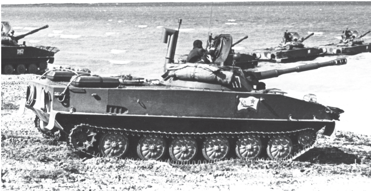
Плавающие танки морской пехоты ВМФ СССР во время учебных занятий. На башне установлена воздухозаборная труба двигателя, предотвращавшая захлестывание волнами на плаву.
