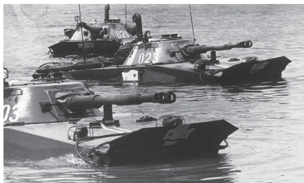
При движении на плаву на носу корпуса откидывался водоотбойный щиток и устанавливался удлинитель наблюдательного прибора механика-водителя.
