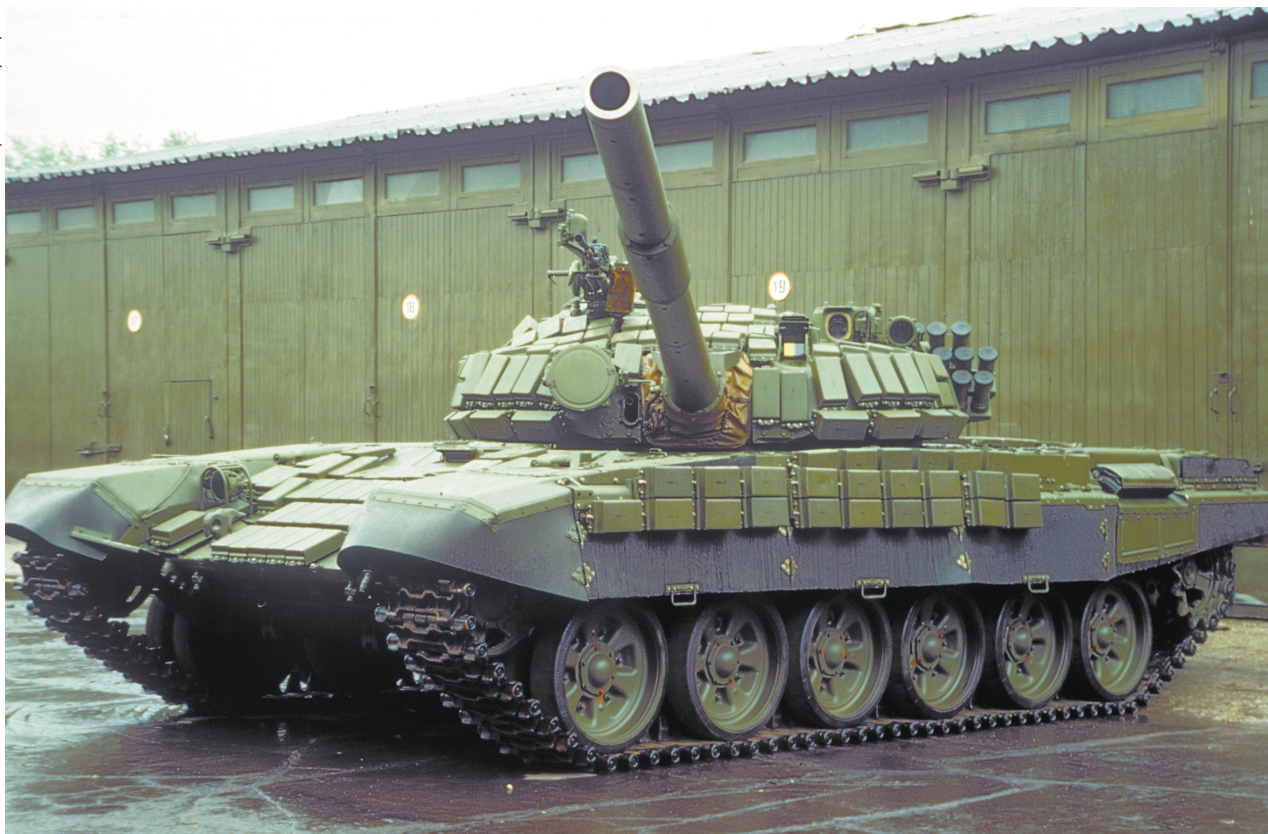
Т-72Б раннего выпуска. Контейнеры динамической защиты на корпусе прикрывают только верхнюю часть борта.
