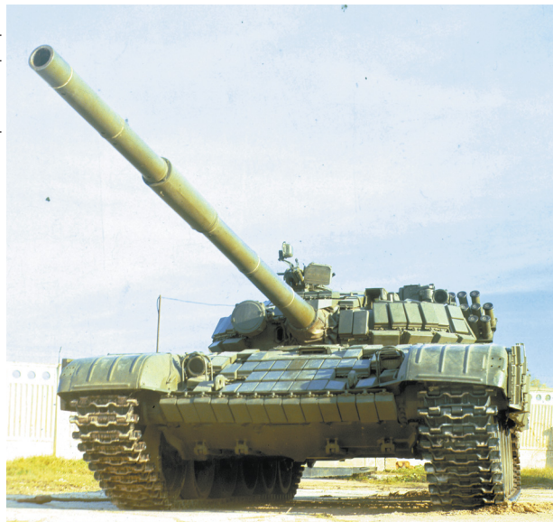
Хорошо видно, что блоки КДЗ «Контакт-1» закреплены и на переднем нижнем листе корпуса танка.
