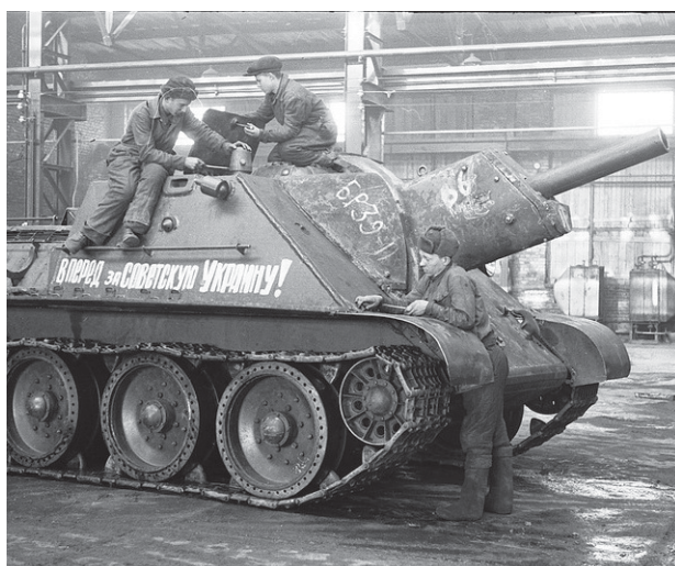
Завершающие работы на готовой самоходке в сборочном цеху завода.
