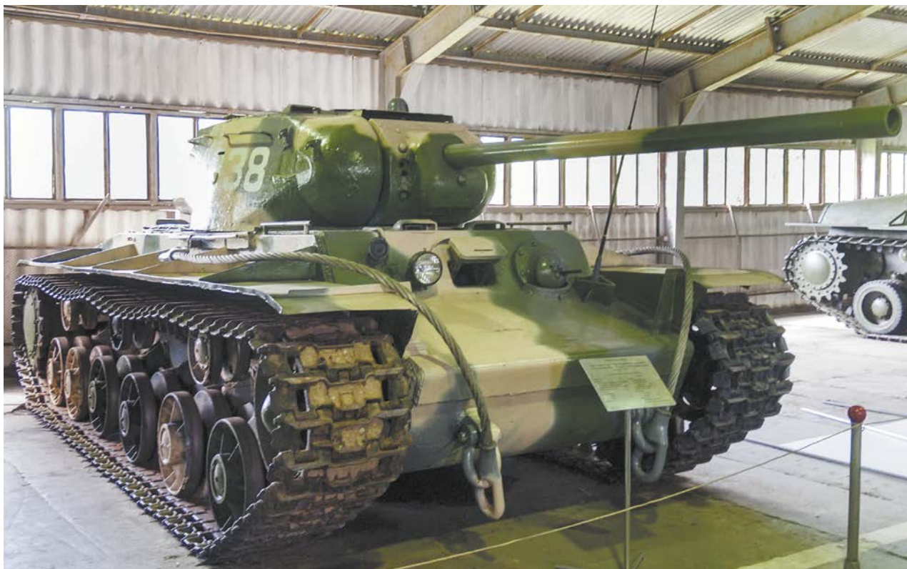
Один из экспериментальных вариантов – KV-1С с 85-мм орудием С-31 – испытывался под обозначением Объект 238 и сохранился до наших дней в Центральном музее бронетанкового вооружения и техники в Кубинке.
