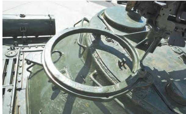
Турель зенитного пулемета ДШКМ в транспортном положении отворачивалась назад, а в боевом — надвигалась на открытый башенный люк.
